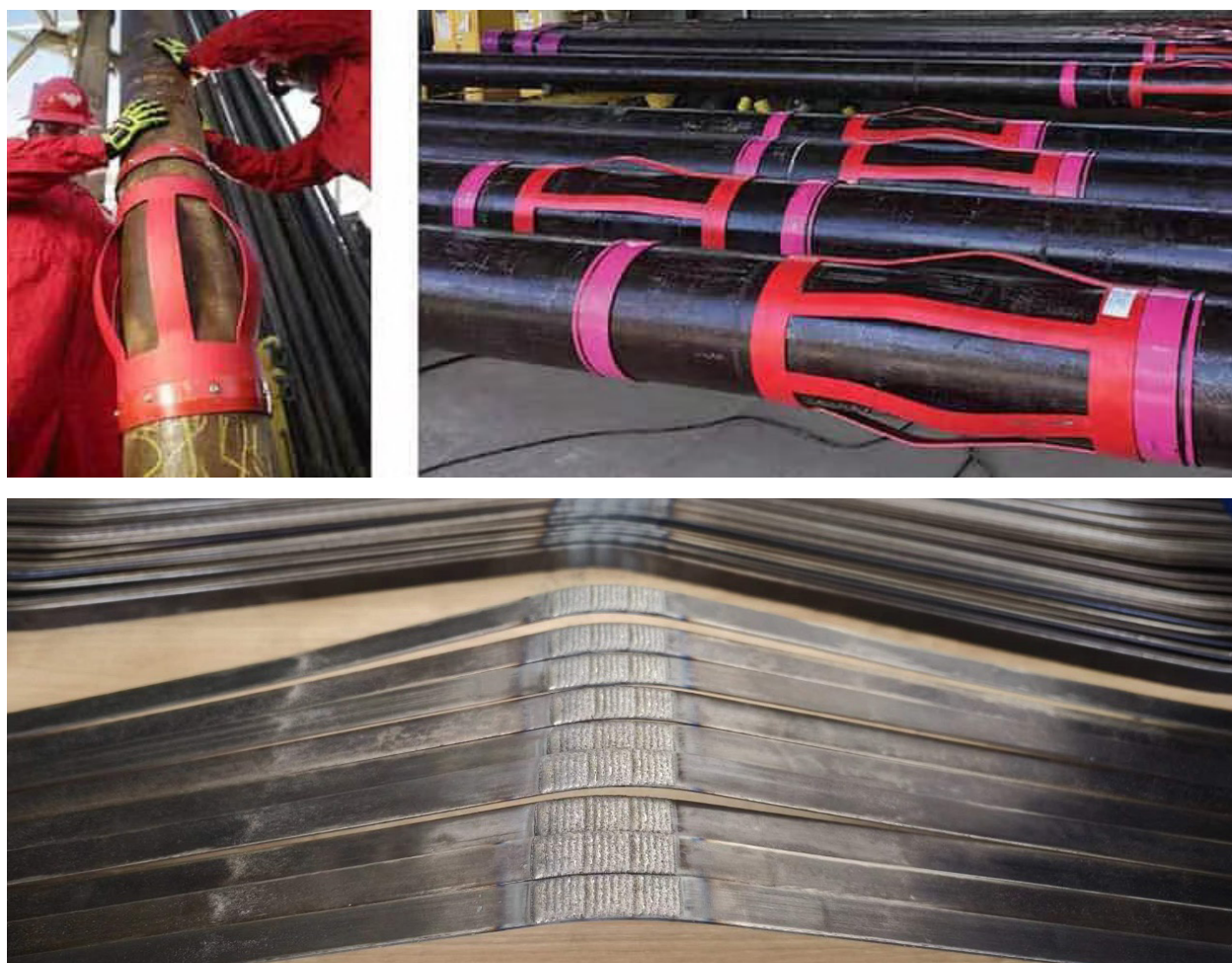
图3 扶正器局部激光熔覆强化
