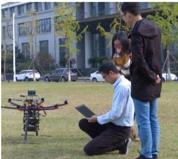
依赖卫星信号的导航系统，一旦进入封闭空间，就会失去作用。“面向智能巡防的多传感器复合导航系统”能有效解决这个问题，即使在密闭空间内，也可以提供导航服务。
